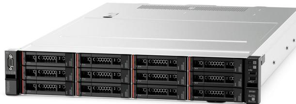
SR590 提供存储灵活性、包含 LOM、ML2 和 PCIe 等多种外形的 NIC 扩展以及可更换 I/O 扩展卡，可实现各种适配器插槽配置。
